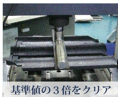
■ 耐衝撃試験 (試験：JIS A5402 に準拠、基準値：鋼球 530g・高さ 30cm 以上)
